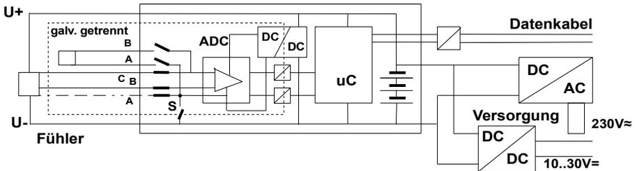
Die analogen Eingänge sind durch photovoltaische Relais untereinander galv. getrennt. Neu bei diesem Gerät ist die zusätzliche Trennung der Messeingänge von CPU und Stromversorgung. Zwischen allen Ein- und Ausgängen (auch den nicht galv. getrennten Analogausgangskabeln) ist ein Potentialunterschied von maximal 50 V zulässig. Die Spannung an den Messeingängen selbst (zwischen B,C,D und A) darf 12V nicht überschreiten!
